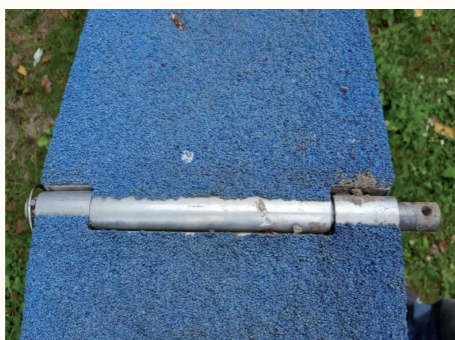
Bei überhöht verarbeiteten Gelenken steigt das Risiko. Die verarbeiteten Sicherungstifte können im Fall des Abrutschens eines Hundes, wenn er z.B. bei feuchtem Wetter auf den blanken, dann rutschigen Metallteil tritt, zu Verletzungen führen. Die Spalten zwischen Belag und Gelenk können für Tiere ebenfalls ein Risiko darstellen – tritt ein Hund unglücklich auf, kann es ihn die Krallen kosten.
